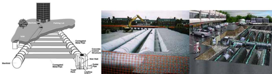
FIGURA 19 – ESEMPIO DI STRUTTURE DI LAMINAZIONE COSTITUTE DA TUBAZIONI SOTTERRANEE E SOVRADIMENSIONAMENTO DEL SISTEMA DI DRENAGGIO DELLE SUPERFICI IMPERMEABILI
